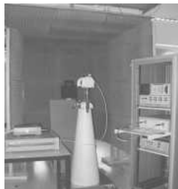
Figure 10.2 – Chambre anéchoïque pour la mesure d'antennes
